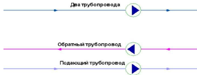
Рисунок 16 – Однолинейное изображение (вверху) и внутреннее представление (внизу) сети с насосными станциями
