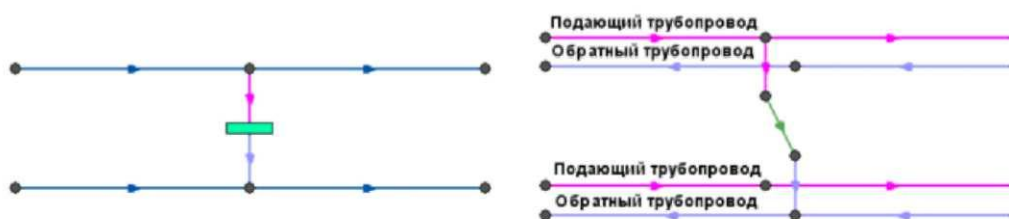
Рисунок 21 – Однолинейное изображение (слева) и внутреннее представление (справа) сети с перемычкой между подающим трубопроводом одного участка и обратным трубопроводом другого участка
