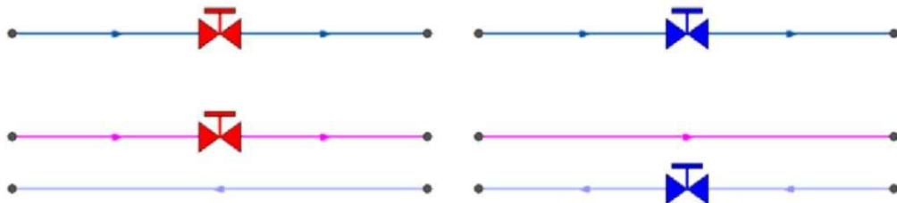
Рисунок 25 – Однолинейное изображение (вверху) и внутреннее представление (внизу) сети с регуляторами давления
